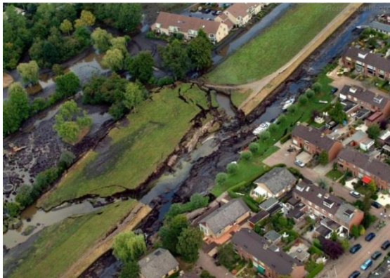
Figuur 9-6 Overstroming van Wilnis door het falen van een veenkade in een droge periode in augustus 2003.
