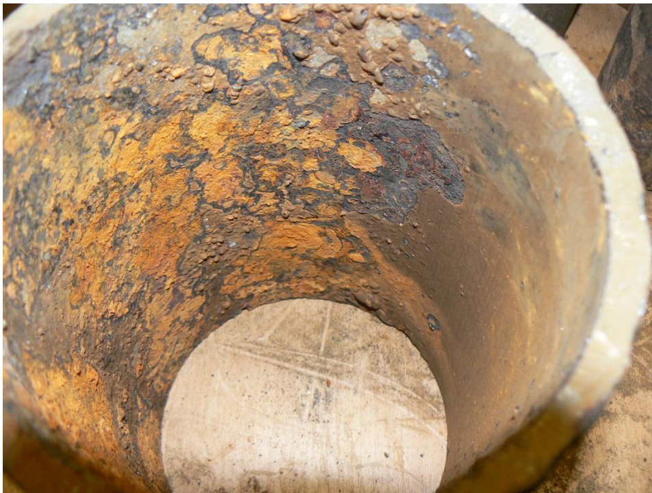
Figuur 3 Grijs gietijzeren leiding met coating
