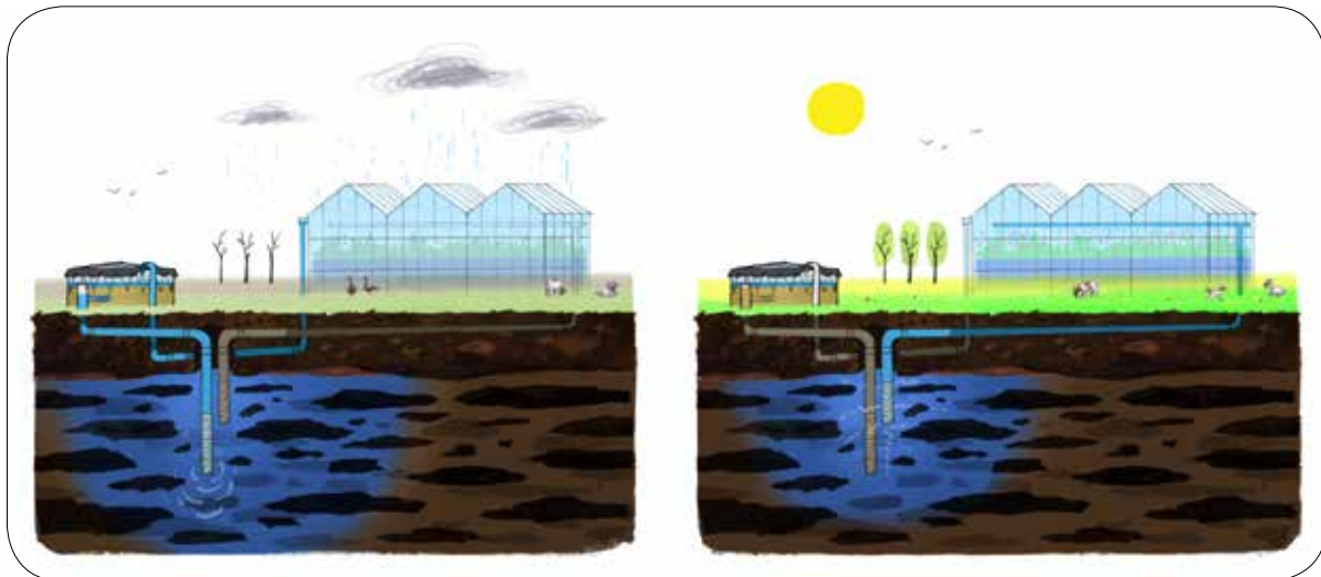
Afbeelding 1: Opslag van overtollig hemelwater in de glastuinbouw ten behoeve van irrigatie. Voorzuivering vindt plaats via snelfilters en een langzaam zandfilter ter verwijdering van zwevend stof
