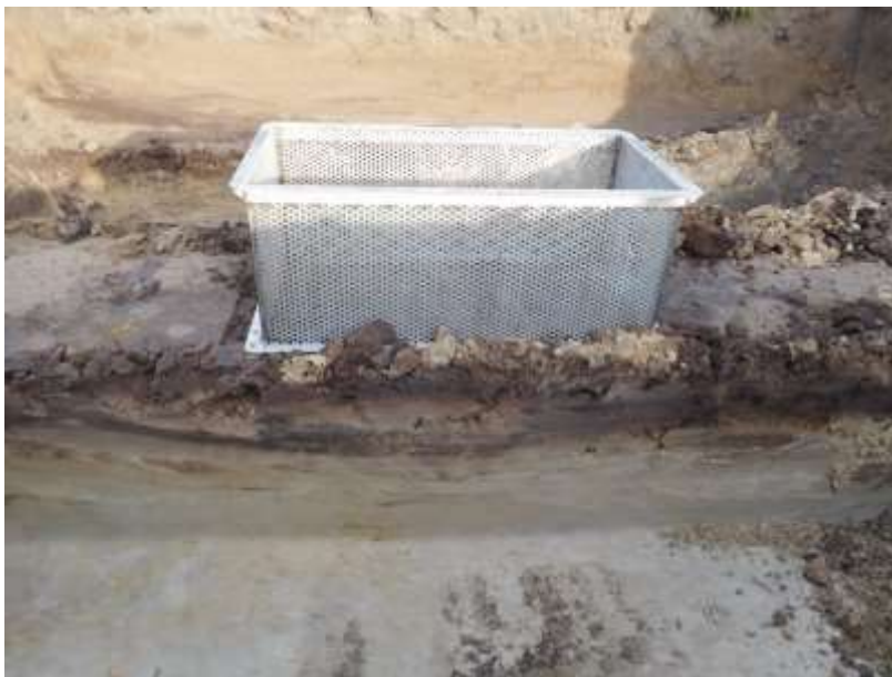
Figuur II-3: Geperforeerde RVS-mantel voor het steken van een ongestoorde bodemkolom en profiel van de bodemkolom (kolom 2)
