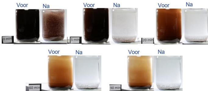
Afbeelding 8. Sedimentatie van deeltjes in het reinwater van productielocatie Vessem vóór- en ná in bedrijf nemen nafilts in de tijd (0 tot 90 minuten) bepaald met een bezinkexperiment
