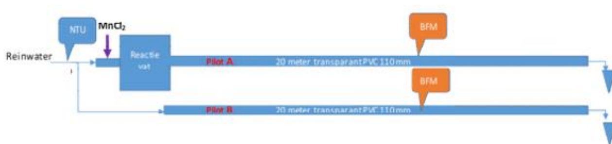
Afbeelding 2. Schematische weergave van de proefinstallatie met daaraan gekoppeld de biofilmmonitoren
