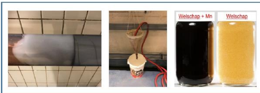
Afbeelding 4. Leidingdeel met propreiniging (links), het opvangen van het sediment in een 10 µm-planktonnet (midden) en de monsterflessen met het verzamelde sediment
