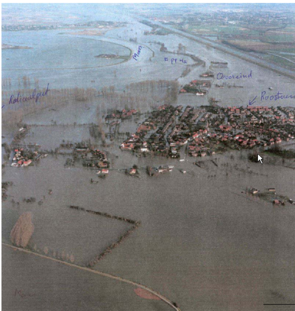
Figuur 15. Roosteren: Maaspeil NAP +29,40 m. Volledige inundatie van het terrein en de kern Roosteren (Vewin, 2002)
