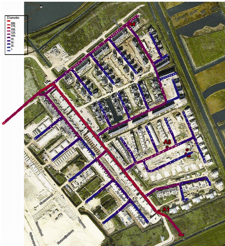
Figuur 2-1 De plattegrond van wijk A "de Watertuinen", het vertakte net. Bron: Google Earth.
