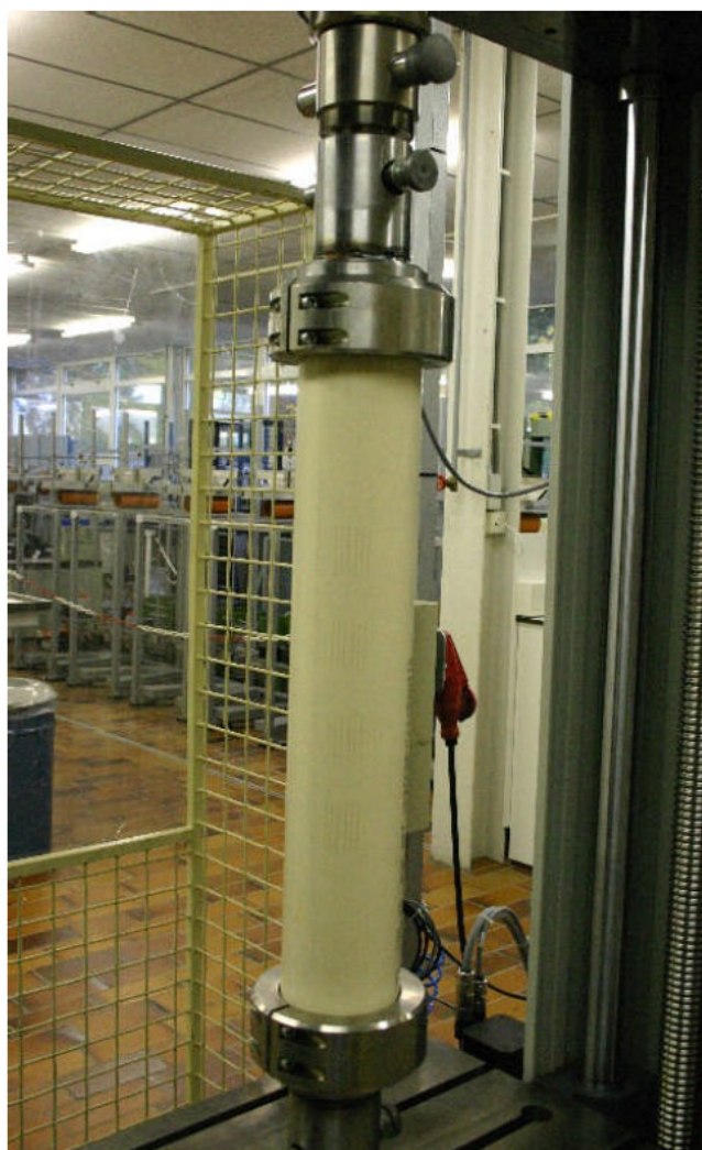
Figuur 2 Foto gesleufde Apollo buis bij een buistreksterkte bepaling
