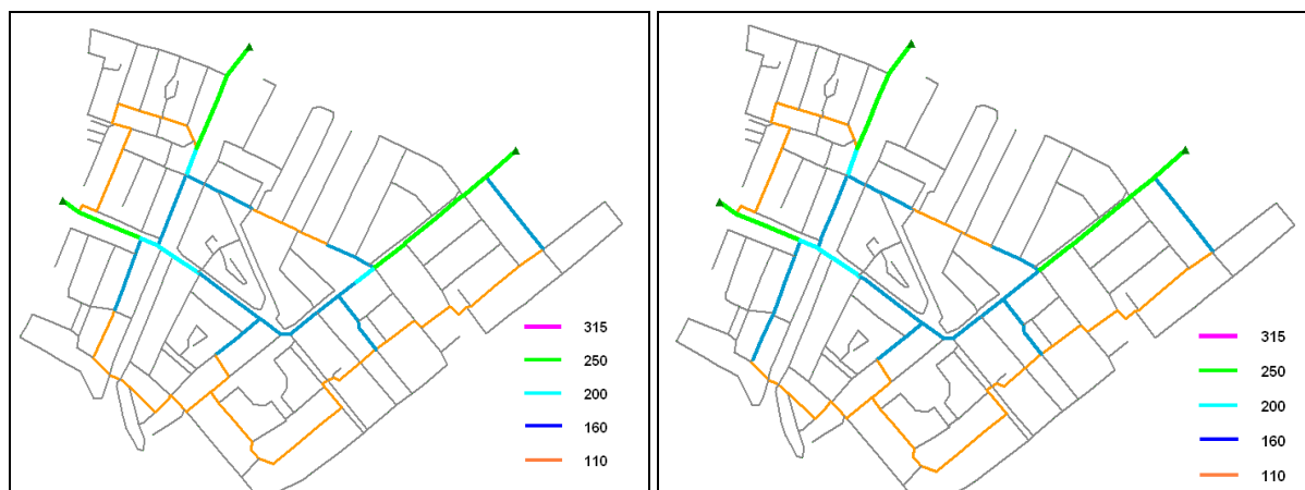
Figuur 6-12 a. Hoofdstructuur met snelheid < 0,4 m/s van 190,2 naar 152 mm; b. Lus met drukgradiënt > 40 Pa/m van 104,6 naar 152 mm
