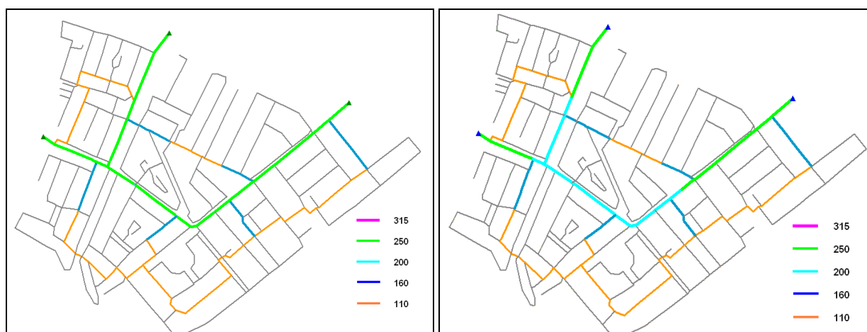
Figuur 6-11 a. Na berekening, lussen met drukgradiënt > 50 Pa/m van 104,6 naar 152 mm; b. Hoofdstructuur met snelheid < 0,4 m/s van 237,4 naar 190,2 mm
