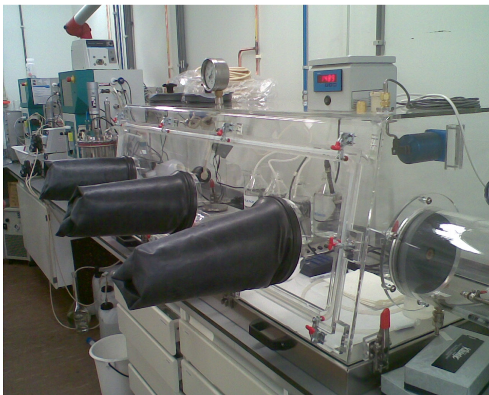
Figuur 4-2: Proefopzet voor reductie-experimenten in de glove-box
