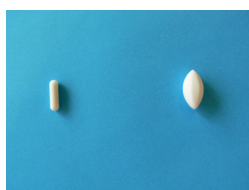
Figuur 4-1: verschillende typen roervlo gebruikt om een mengtijd < 5 s mogelijk te maken.
