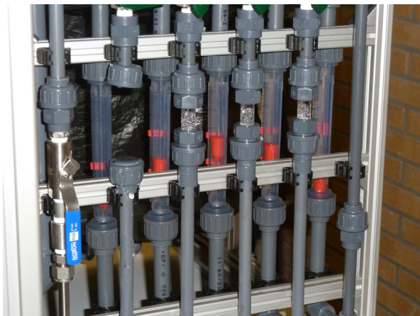
Figuur 4: CBM met debietmeters en buisjes met glazen parels
