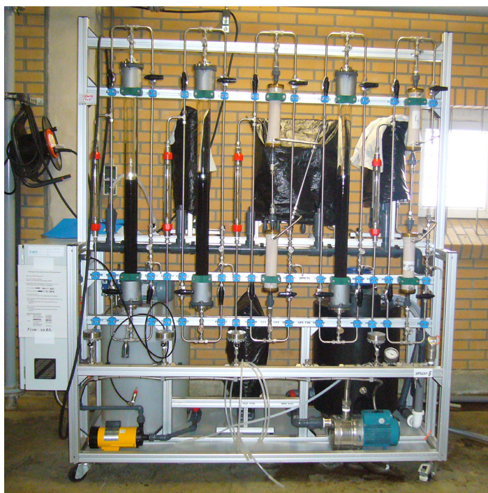
Figuur 1: Foto van de Diagnosetool met CBM's in Spannenburg
