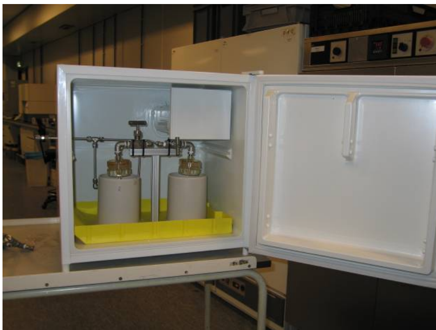
Figuur 4.1. Indruk van de tap sampler zoals die toegepast is in Annen en omgeving, de afmeting van de koelkast is ca 60*60*60, en daarmee handzaam om eenvoudig in te zetten.
