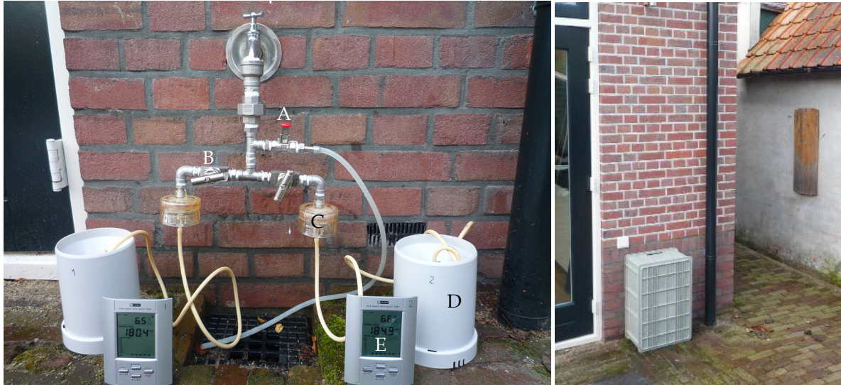
Figuur 3.1. Tap sampler opstelling: A. spoelkraan; B. naaldkraan; C. filterhouders; D. regenmeters en E. uitlees unit regenmeter.
