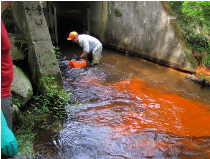
Figuur 3-4 Tracerdosering volgens de 'gulp-methode' (foto: USGS/ Denis LeBlanc)
