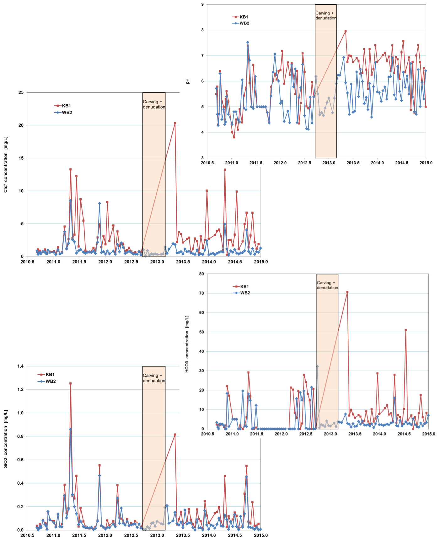
FIG. 6.18. Verloop in chemische samenstelling van bulk neerslag op vangers KB1 en WB2 in de hele meetperiode (september 2010 t/m december 2014).
