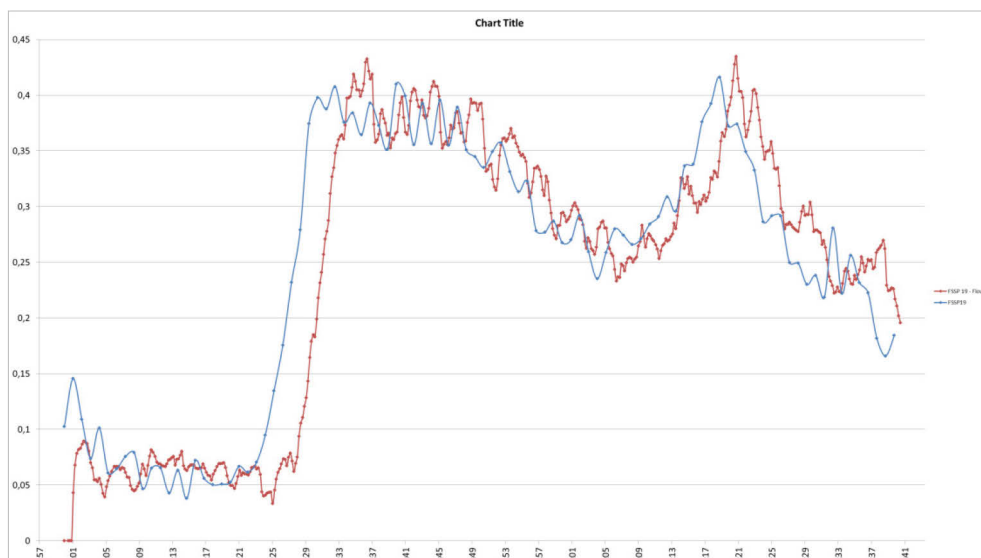
FIGUUR 9. VOORBEELD VAN GEWENSTE (BLAUWE CURVE) EN GEMETEN (BRUINE CURVE) VOOR EEN VERBRUIKSPUNT IN DE PROEFINSTALLATIE. OP DE HORIZONTALE AS STAAT DE TIJD MET TICKMARKS ELKE 4 SECONDE. OP DE VERTICALE AS STAAT HET VERBRUIK IN LITERS PER SECONDE.
