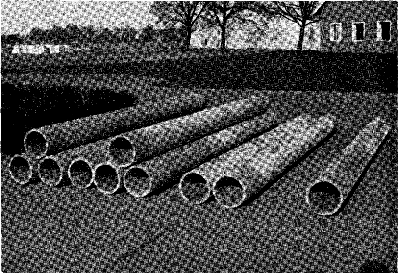
Afb. 6. De buizen na het wegtrekken van de klossen
