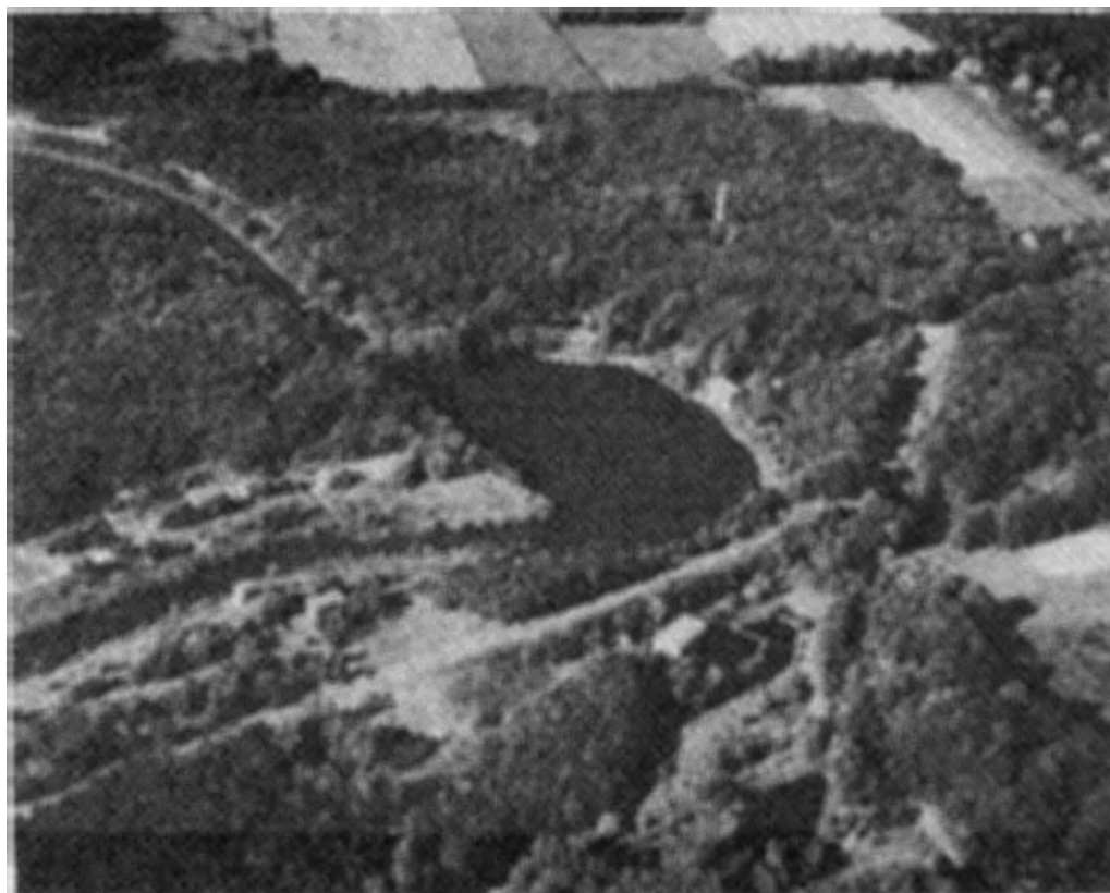
Fig. 10.2 - De Oranjekom, gegraven rond 1850, waarop alle draine- rende kanalen uitmonden die al het gewonnen water transporteren. Deze kom vormt het eindpunt van de duininfiltratie (foto Aerophoto Schiphol B.V.)
