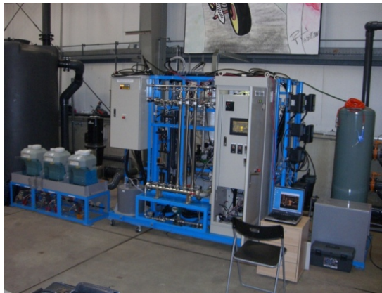
Figuur 4-5 Bench-scale installatie NGK in proevenloods bij PWN.
