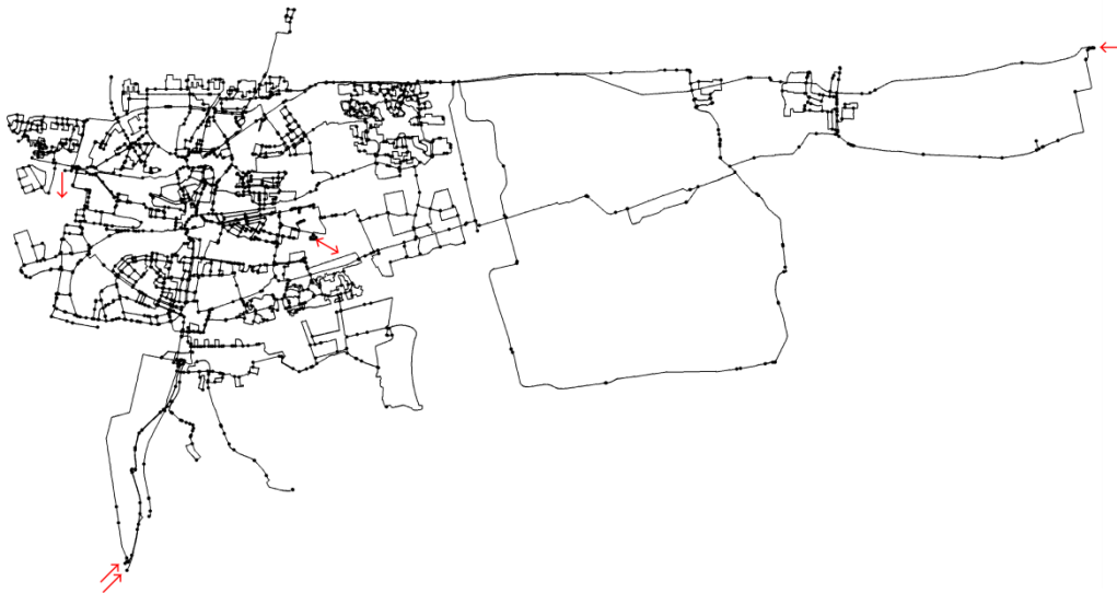
Figuur 4: Hydraulisch model LW2700 met in- en uitgaande waterstromen (rode pijlen).
