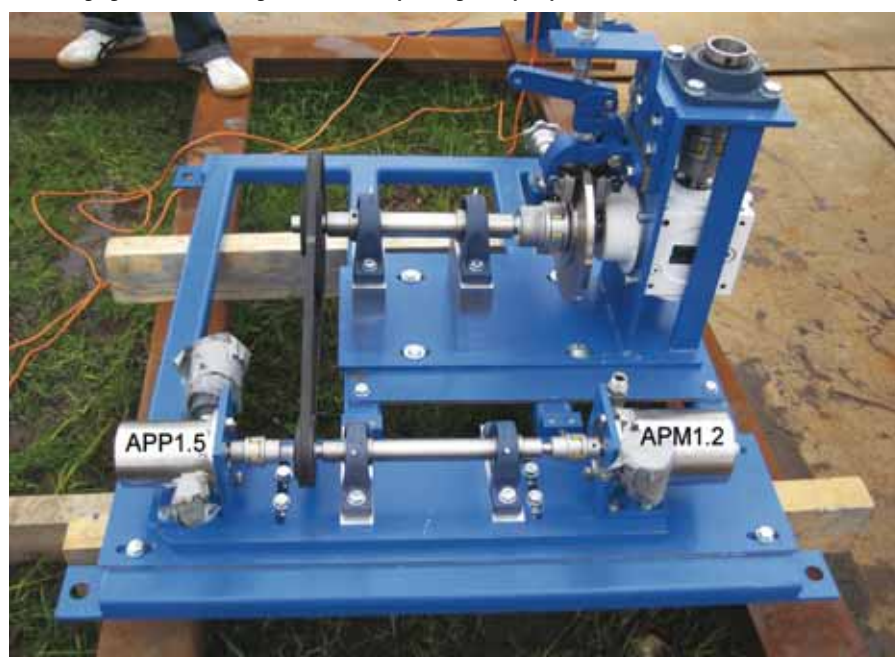
Overbrenging van de windenergie rechtstreeks op de hogedrukpomp.
