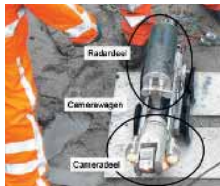
Cameraswagen met georadarmeting.
