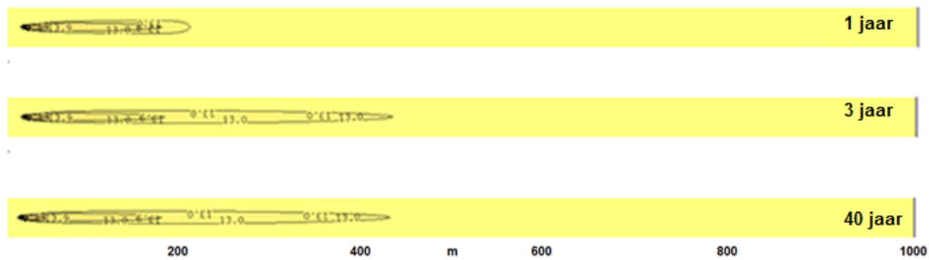
FIGUUR 5.5: GEMODELEERDE VERSPREIDING (49) VAN WARMTE IN DE RICHTING VAN GRONDWATERSTROMING (VAN LINKS NAAR RECHTS) MET EEN SNELHEID VAN 32CM/DAG (117M/JAAR) VOOR VERSCHILLENDE TIJDEN NA AANVANG WARMTEUITSTRALING DOOR EEN PUT VAN 80°C. DE BUITENSTE CONTOUR GEEFT 13°C WEER. AFSTANDEN ZIJN IN METERS VANAF DE PUT.
