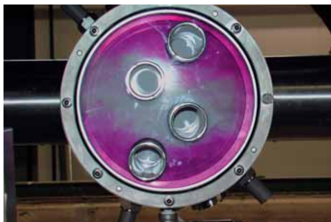
Visualisatie verblijftijd en menging met behulp van een kleurstof.
