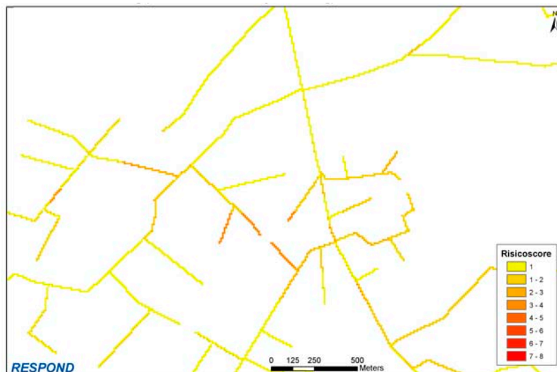
Figuur 40 Belastingscore riolering voor virussen, gecorrigeerd voor de kans op lekkage
