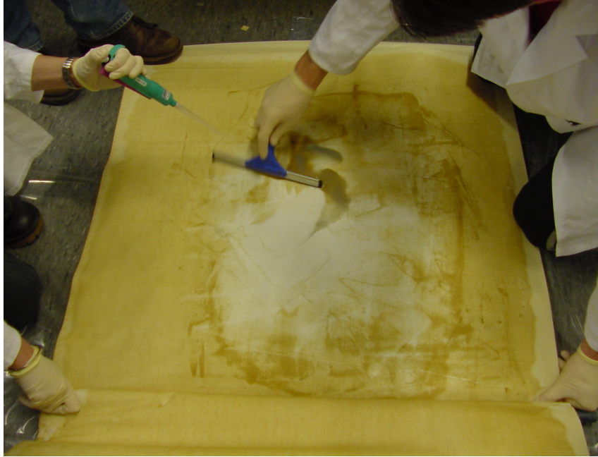
Figuur 5.9 Opendegevouwen element 2-6 tijdens het verzamelen van geaccumuleerd materiaal op de voedingszijde van het membraan (14 juni 2005).
