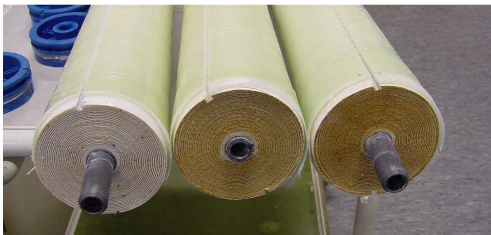
Figuur 5.7 Voedingszijde van membraanelementen na verwijderen van eindkappen; V.l.n.r. de membraanelementen van de locaties 1-1b, 2-6 en 3 (14 juni 2005).
