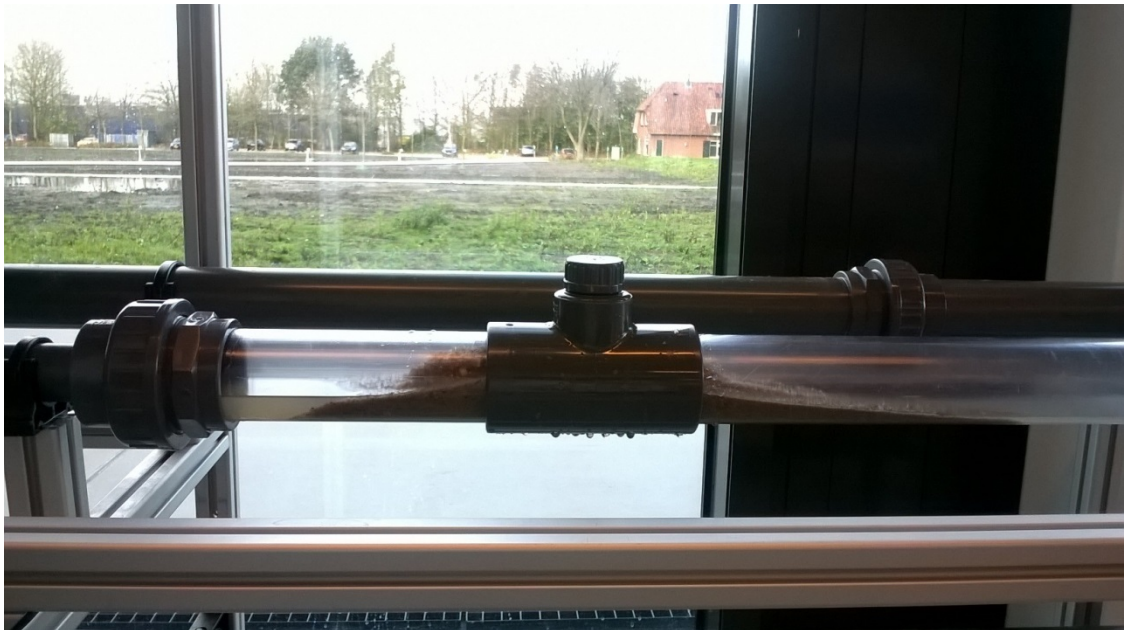
FIGUUR 11. DOSERING VAN ZAND EN WATER IN EXPERIMENT 3. WAARBIJ ZICHTBAAR EEN GEDEELTE VAN HET WATER MET VERONTREINIGING NIET VERDER DE LEIDING IN KAN STROMEN OMDAT HET WORDT TEGENGEHOUDEN DOOR HET ZAND.
