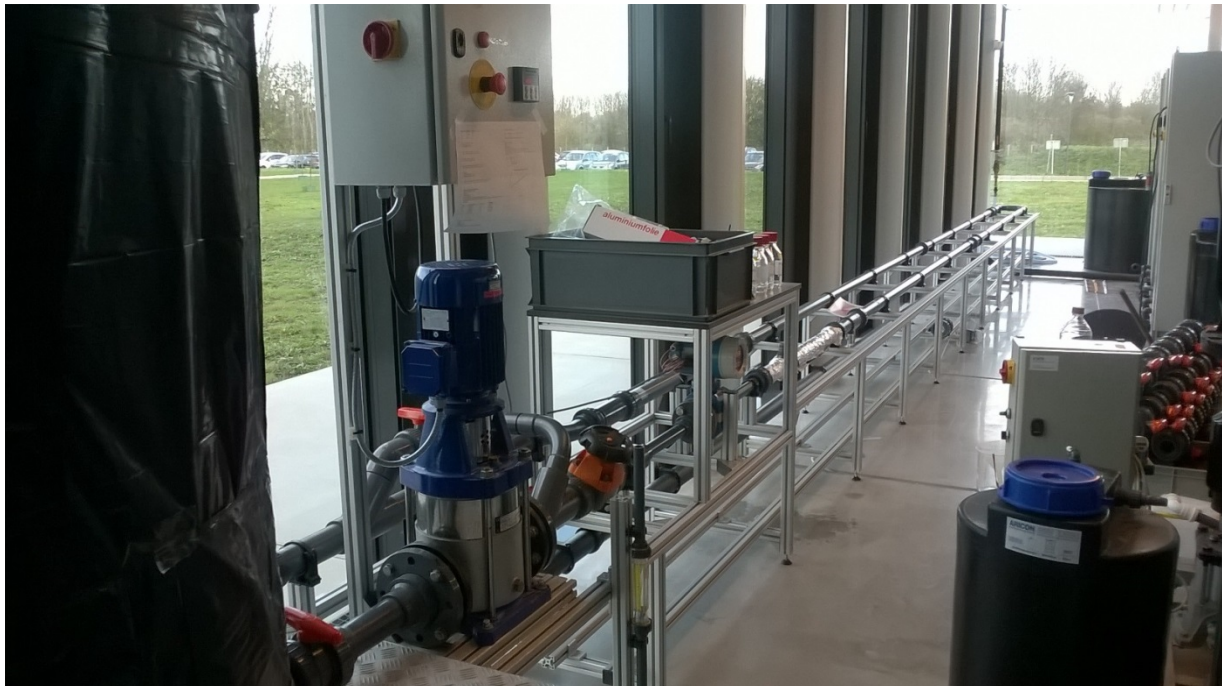
Pilot distributienet waarin de experimenten zijn uitgevoerd. Links het spuiat, gevolgd door de pomp met daarachter 20 meter leidingen die een distributienet simuleren.
