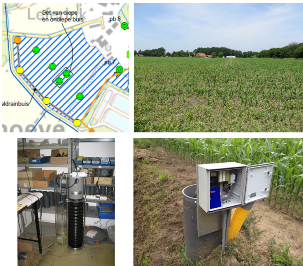
Figuur 2.2: Klimaat Adaptieve Drainage (KAD) systeem: drains, verbonden met een gesloten verzameldrain, die uitmondt in een verzamelput met op afstand regelbaar gestuurd drainageniveau via telemetrie, en een afvoerleiding naar het oppervlaktewater.
