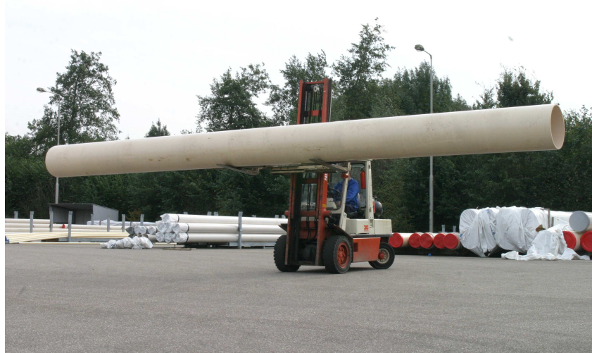
3.5.2 Bescherming van leidingmaterialen tijdens transport (zo NIET dus).
