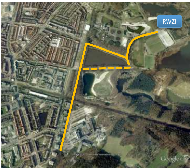
Figuur 9. Twee mogelijke tracés van de persleiding naar de Pharmafilter®-zuivering. De oude RWZI zichtbaar op de foto is afgebroken. De nieuwe RWZI ligt op de aangegeven locatie.
