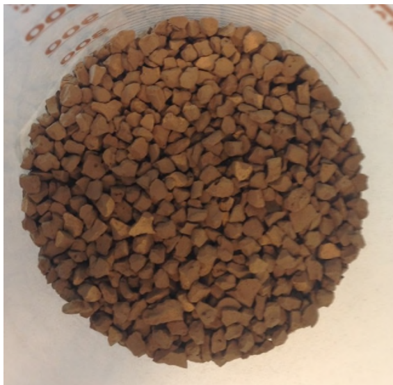
FIGUUR 6-1 FOTO GRANULAIR WATERIJZER, FRACTIE 3,2 - 4 MM.
