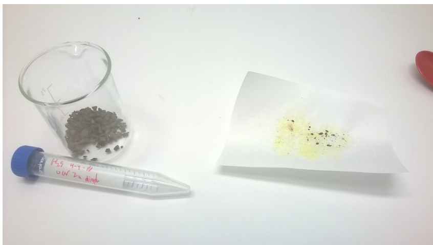
FIGUUR 8-1 FOTO MAXIMAAL BELADEN ONTBRANDE WATERIJZERKORRELS.
