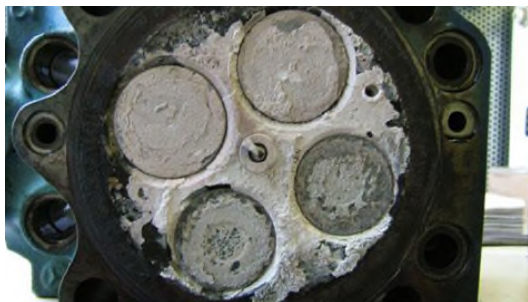
FIGUUR 3-2 SILICIUM AFZETTINGEN IN EEN WKK (JONKER 2016).
