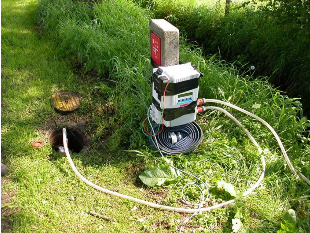
Figuur 14 Troebelheidsmeting (on line) op de leiding via een brandkraan (herkomst foto onbekend).
