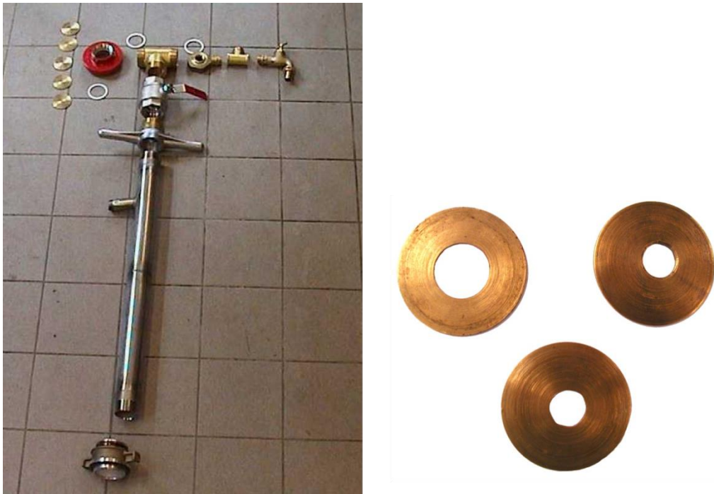
Figuur 13 Standpijp voor een brandkraan voor een OPM met mogelijkheid voor een insteekmeter (volumestroom of druk), kogelafsluiter, monsterkraan en kaliberplaten voor het beperken van de volumestroom afhankelijk van de leidingdiameter (herkomst foto onbekend).
