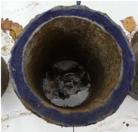
Figuur 3 Resultaat van een thymolftaleïnetest op een 100 mm asbestcement buisdeel met een wanddikte van ongeveer 14 mm. Er is inwendige aantasting (maximaal 2 mm) en uitwendige aantasting (maximaal 6 mm) zichtbaar.
