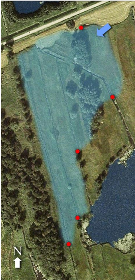
Figuur 6.2. Het gedeelte van de Kiersche Wiede waarin zomerinundatie plaatsvond in 2013 en 2014. De pijl geeft de plek aan van waaruit het inundatiewater is ingelaten, en de rode stippen geven de lokaties aan waar de divers zijn afgesloten om het gebied te isoleren.
