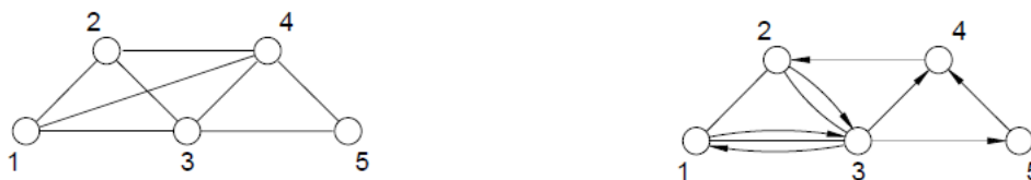
FIGUUR 3-2: LINKS: CORRELATIEVE GRAAF TUSSEN DE INFORMATIEBRONNEN 1, 2, 3, 4 EN 5, WAARBIJ COORELATIEVE VERBANDEN MET LIJNSTUKKEN ZIJN WEERGEGEVEN EN VARIABELEN ALS KNOPEN (BOLLETJES); RECHTS DE CAUSALITEITSGRAAF VAN HETZELFDE ONDERLIGGENDE SYSTEEM. IN EEN CAUSALITEITSGRAAF WORDT DE RICHTING VAN DE INFORMATIESTROOM ALS PIJL WEERGEGEVEN. UIT: DAHLHAUS & EICHLER, 2003.
