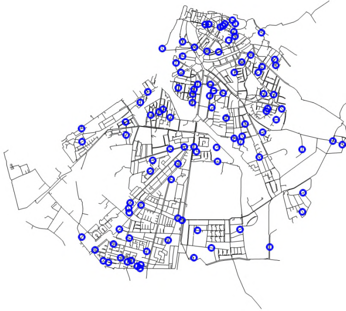
FIGUUR 4-1. LEIDINGNETMODEL NIJMEGEN MET 100 BRONLOCATIES (BLAUWE CIRKELS) GEBRUIKT IN DE VERONTREINIGINGSSCENARIO'S IN OPTIMALISATIE EN PRESTATIEBEPALING VAN SENSORNETWERKEN .
