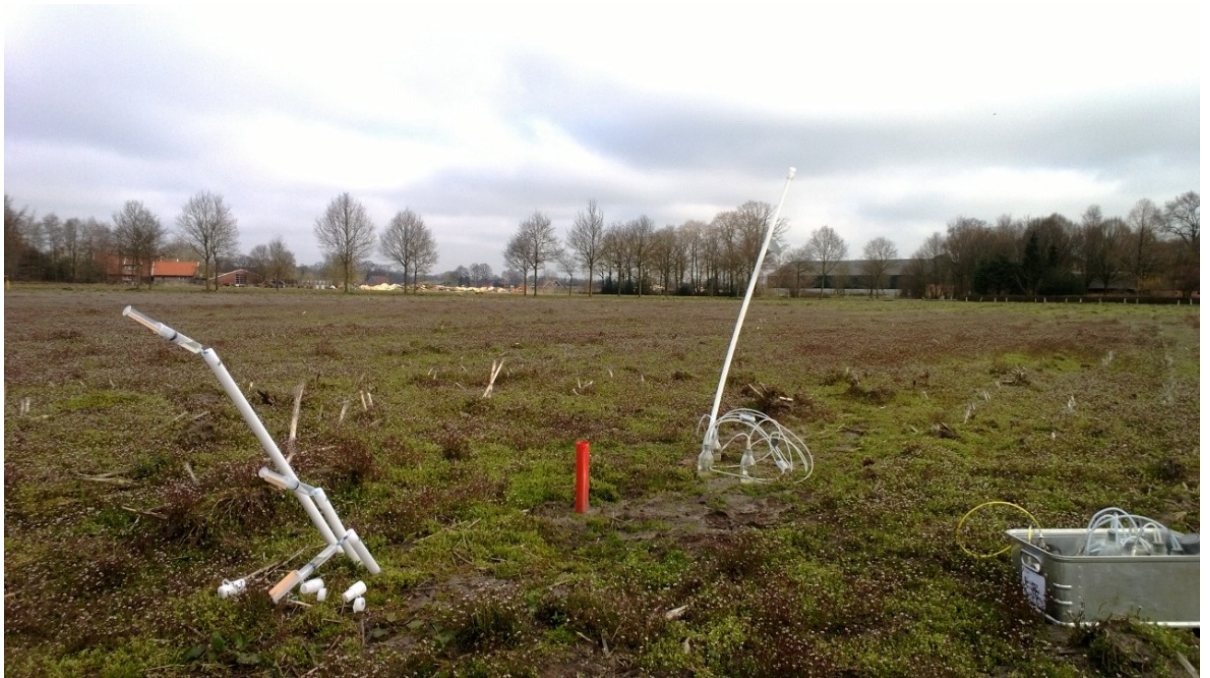
FIGUUR 2-12: MEETOPSTELLING EN BEMONSTERING VAN BODEMVOCHT MET MACRORHIZONS (LINKS) EN GRONDWATER MET MINIFILTERS (RECHTS) TER PLEKKE VAN MP3. FOTO: RUUD BARTHOLOMEUS.
