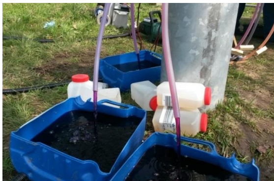
Fig 2. Paars water (met permanganaat) wordt opgepompt uit een waarnemingsput
