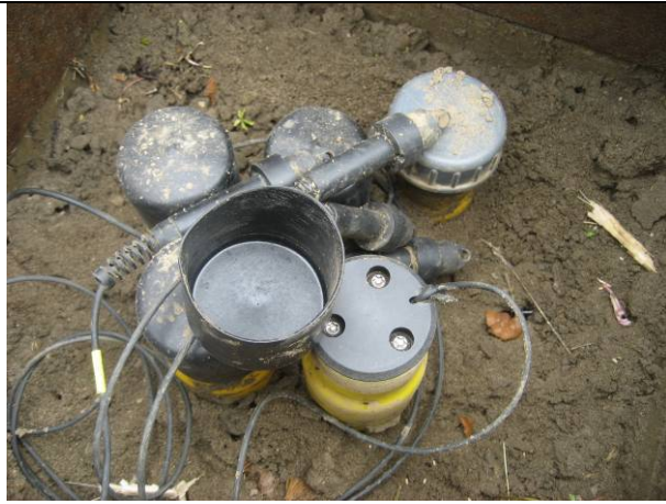
Figuur 21-9 Peilbuizen afgewerkt met beveiligde dop en waterdichte kap.
