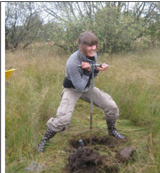
Figuur 21-2 Uitvoering van handboring met behulp van een edelman boor (KWR)
