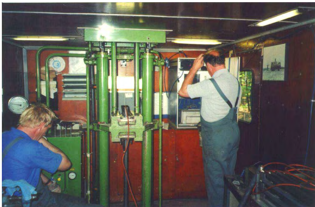
Foto 5-1 Uitvoering van een sondering; een vorm van geofysisch onderzoek (M. Balemans, KWR)
