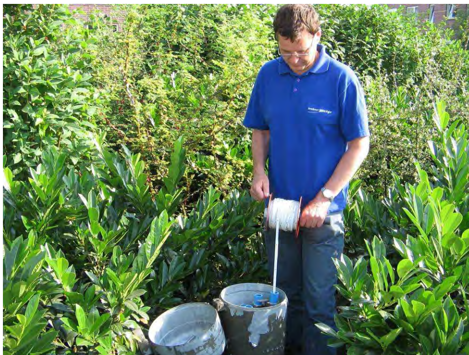
Foto 16-1 Het meten van een grondwaterstand met behulp van een peillint (foto Carl van Rosmalen, Brabant Water)
