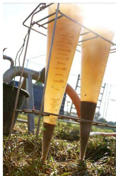
Figuur 11-11 Bepalen zand en slib bij jetten (Foto Brabant Water)
