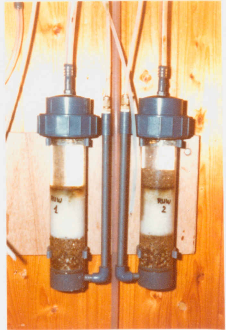
Fig. 3.15 Verstopt proeffilter, 55 mm diameter, glasparsels (0,15 mm) wel en niet afgedekt met grove parels (2 mm). Doorstroomd met drinkwater te Andijk, vanaf 16 augustus 1976.
