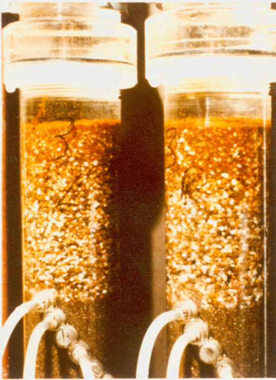
Fig. 3.14 Verstopt omstoringsgrind na filterdoorslag. Infiltratiewater 2e persput Duinwaterleiding van 's-Gravenhage, 1975.
