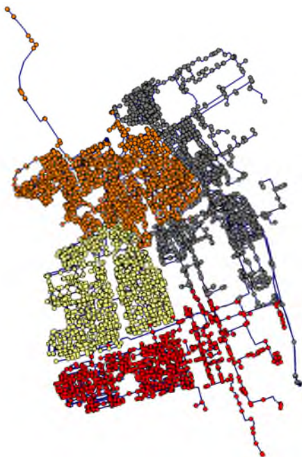
(c) DMA indeling voor Delft voor d=7.5 \text{ m}^3/\text{u} en c=10\% , zonder industriegebied.
