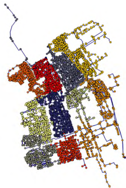
(d) DMA indeling voor Delft voor d=7.5 \text{ m}^3/\text{u} en c=20\% , zonder industriegebied.
