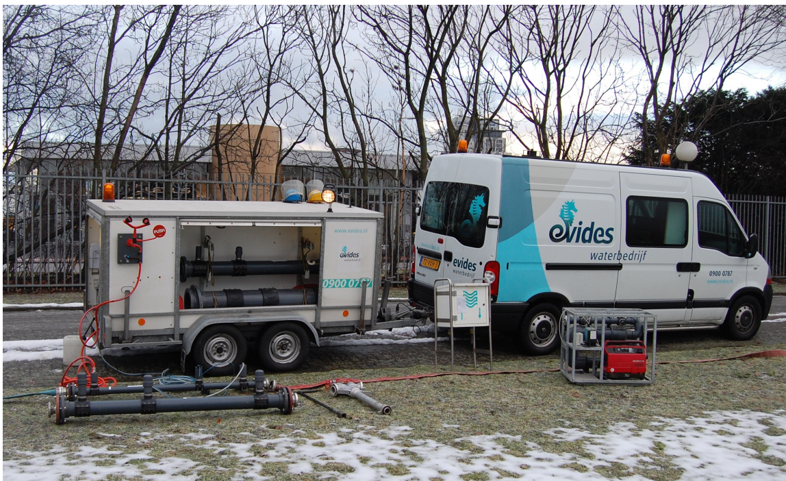
Figuur 3 Overzicht van mogelijke hulpapparatuur voor desinfectie van het leidingnet.
