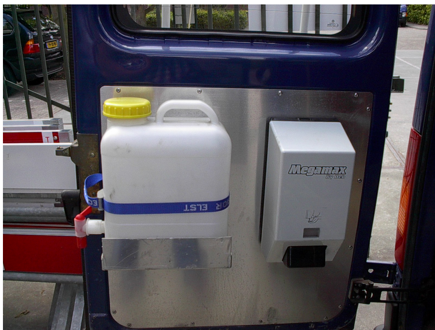
Figuur 2 Voorzieningen in een monteursbus ten behoeve van hygiënisch werken.
