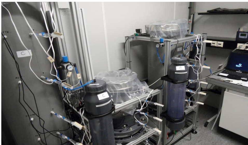
Figuur 3-2 Uiteindelijke opstelling kolommen met beregeningsvoorziening, sensoren, aansturing en waterafvoer. Van links naar rechts: de 1,5 m kolom, de 0,5 m kolom en de 1,0 m kolom
