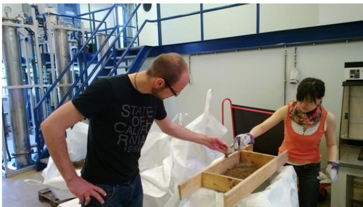
Figuur 3-4 Zeven van het bodemmateriaal om plantenwortels te verwijderen
