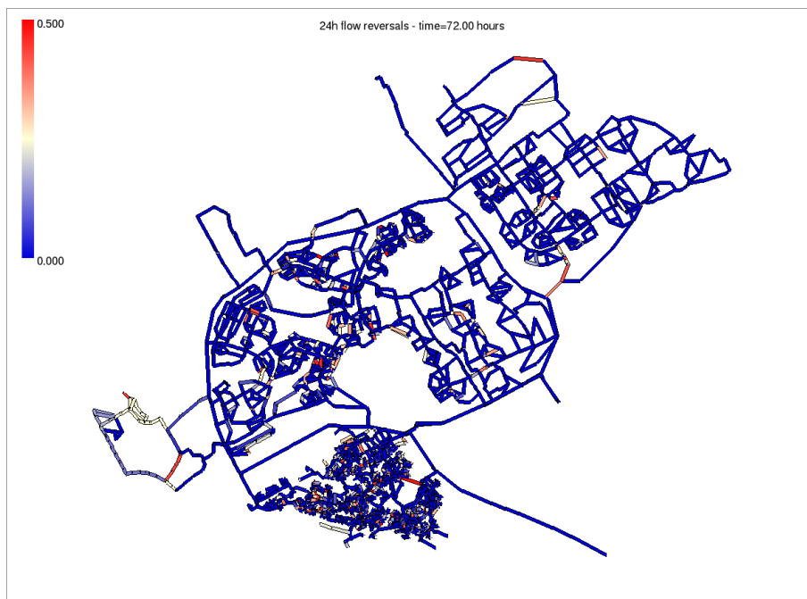
Figuur 28: Illustratie van de variabiliteit van het stromingsveld in het netwerk van Almere gedurende een periode van 24 uur: a) Standaarddeviatie van de volumestroom gedeeld door de gemiddelde volumestroom; b) fractie van de tijd dat de stroomrichting omgekeerd is ten opzicht van de meestvoorkomende stroomrichting. Beide figuren zijn gebaseerd op 12 tijdstippen (interval 2 uur) in 1 realisatie van het stromingsveld en daarom slechts indicatief.
