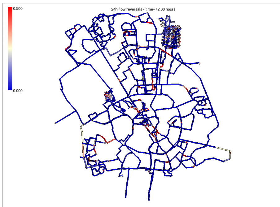
Figuur 19: Illustratie van de variabiliteit van het stromingsveld in het netwerk van Eindhoven gedurende een periode van 24 uur: a) Standaarddeviatie van de volumestroom gedeeld door de gemiddelde volumestroom; b) fractie van de tijd dat de stroomrichting omgekeerd is ten opzicht van de meestvoorkomende stroomrichting. Beide figuren zijn gebaseerd op 12 tijdstippen (interval 2 uur) in 5 realisaties van het stromingsveld en daarom slechts indicatief.
