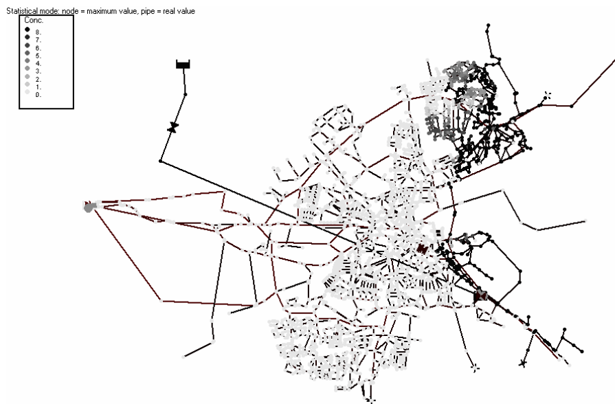
Figuur 13 Verontreinigde (zwart) en niet-verontreinigde modelknoten (grijs) bij verontreiniging van laagreservoir Bornestraat
