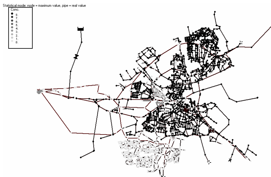
Figuur 14 Verontreinigde (zwart) en niet-verontreinigde modelknopen (grijs) bij verontreiniging van de \varnothing 350 mm transportleiding
