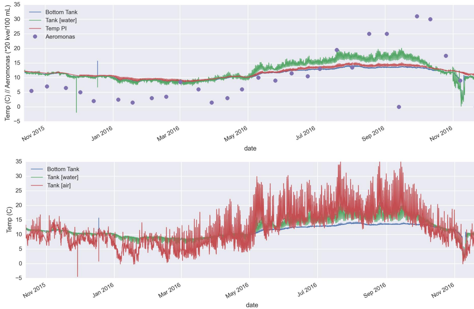
Figuur 3.25 Tijdreeksen van gemeten temperaturen in reservoir De Greuns. Bovenste figuur geeft de verdeling van temperaturen over de tank weer (gemiddelde temperatuur in de tank (groen), op de bodem van de tank (blauw) en op de instroompijp (rood)) met de Aeromonas getallen. Het onderste figuur geeft ook de luchttemperatuur boven de waterlaag weer.
