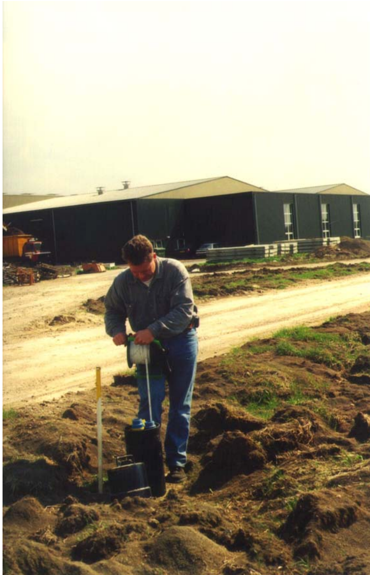
Foto 16-1 Het meten van een grondwaterstand met behulp van een peilapparaat (M. Balemans, Kiwa)
