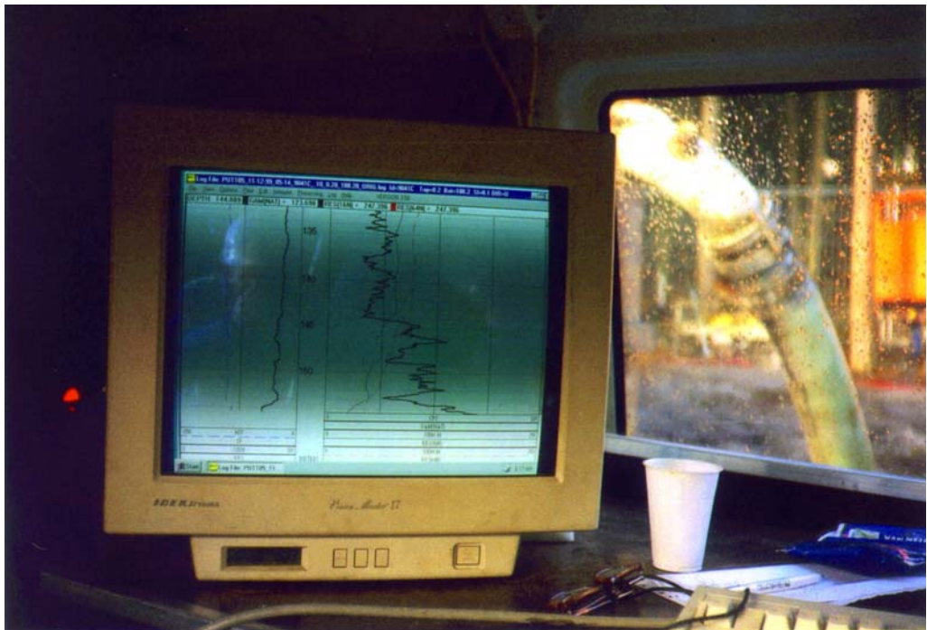
Foto 11-3 De resultaten van een geofysische boorgatmeting worden in het veld direct gepresenteerd (C. van Rosmalen, WOB)
