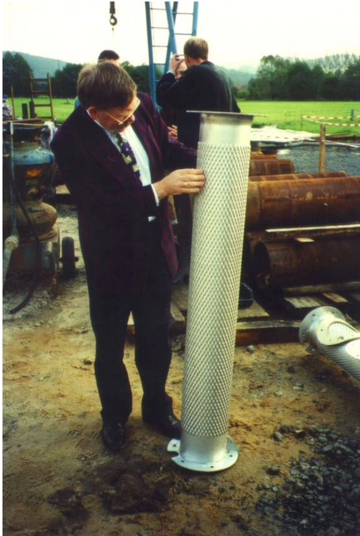
Foto 8-1 Een roestvrijstaal (RVS) putfilter (J.W. Kooiman, Kiwa)
