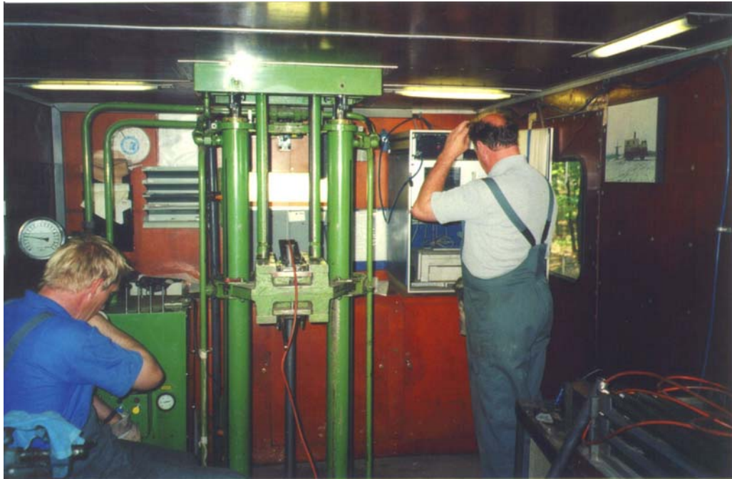
Foto 5-1 Uitvoering van een sondering; een vorm van geofysisch onderzoek (M. Balemans, Kiwa)
