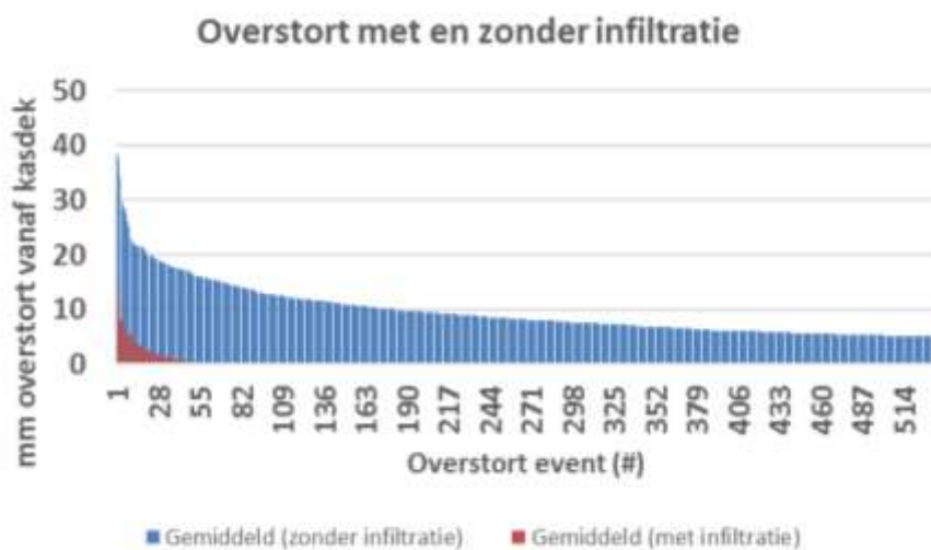
FIGUUR 5-11. OVERSTORT (GEMIDDELD) PER EVENT MET EN ZONDER INFILTRATIE CF. AANGENOMEN REGIME. WATERVRAAG: 682 MM/J
