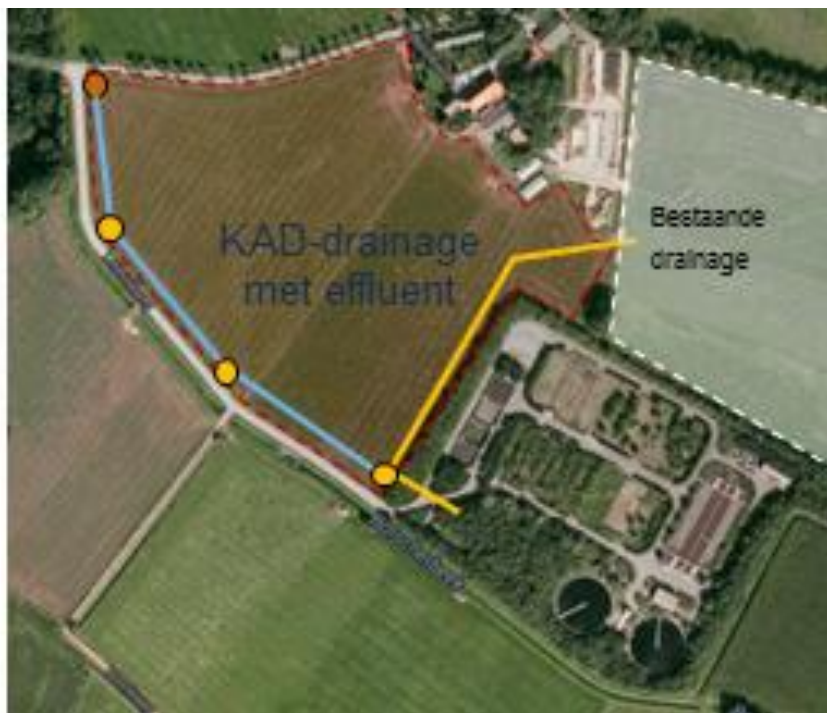
FIGUUR 3-4 PROEFPERCEEL VOOR SUBIRRIGATIE MET RWZI-EFFLUENT TE HAAKSBERGEN.
