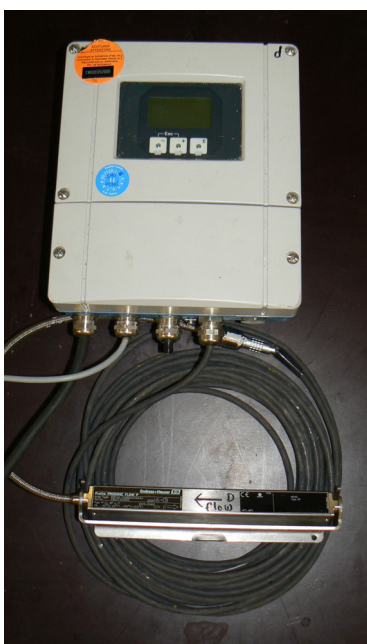
Figuur 4-1 Weergave van een Proline Prosonic volumestroommeter.
