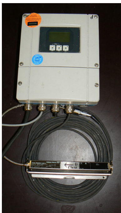
Figuur 3-1 Weergave van een Proline Prosonic volumestroommeter.
